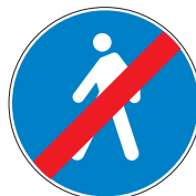
F.R. 260 089 fine percorso pedonale
