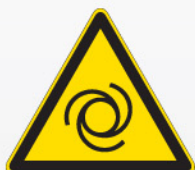
E11 42 K Pericolo avviamento automatico W018 ●
