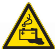
E11 30 X Pericolo batterie in fase di carica W026 ●
